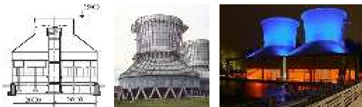
Рис. 69. Одновентиляторная градирня СК-400
