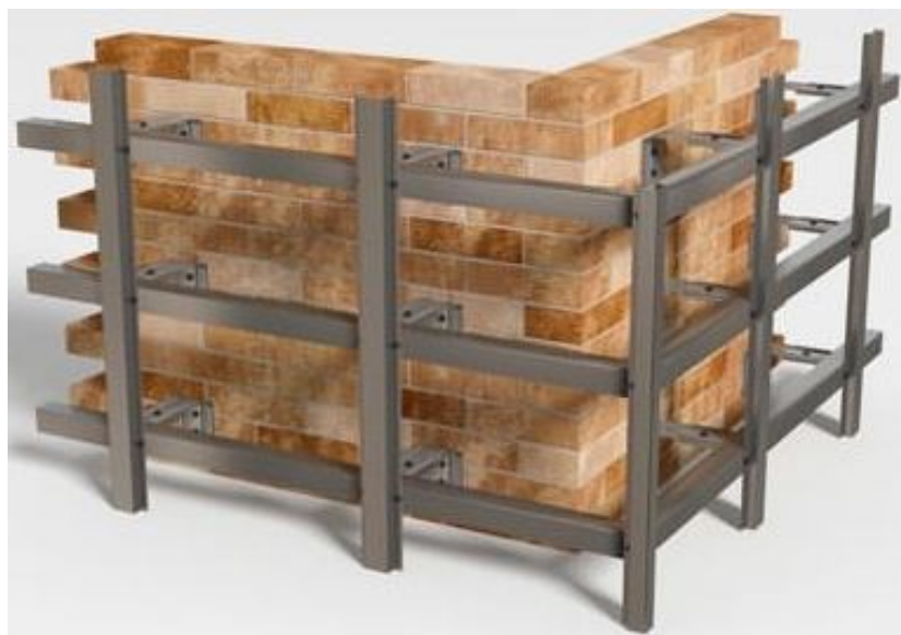
Рис. 9. Горизонтальная и вертикальная подсистемы внешней облицовки.
