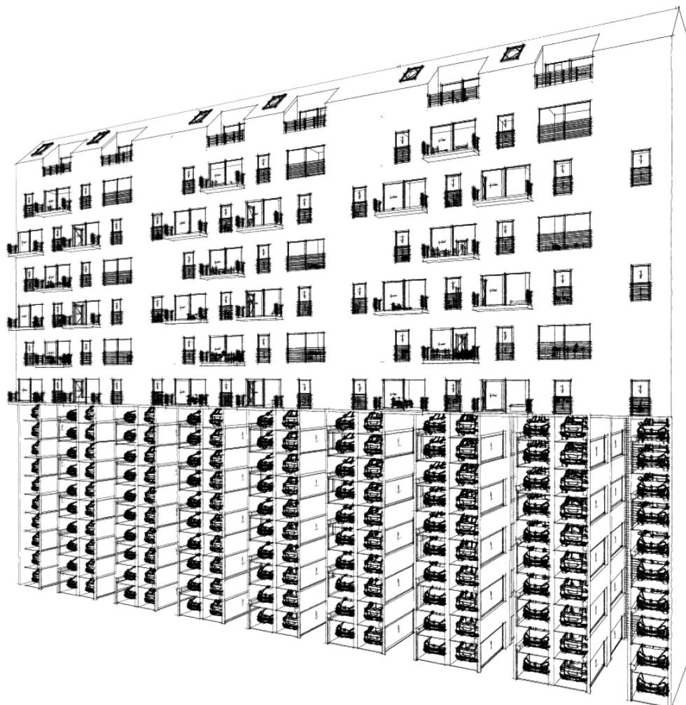
*Схема автостоянки, расположенной под жилым комплексом*
