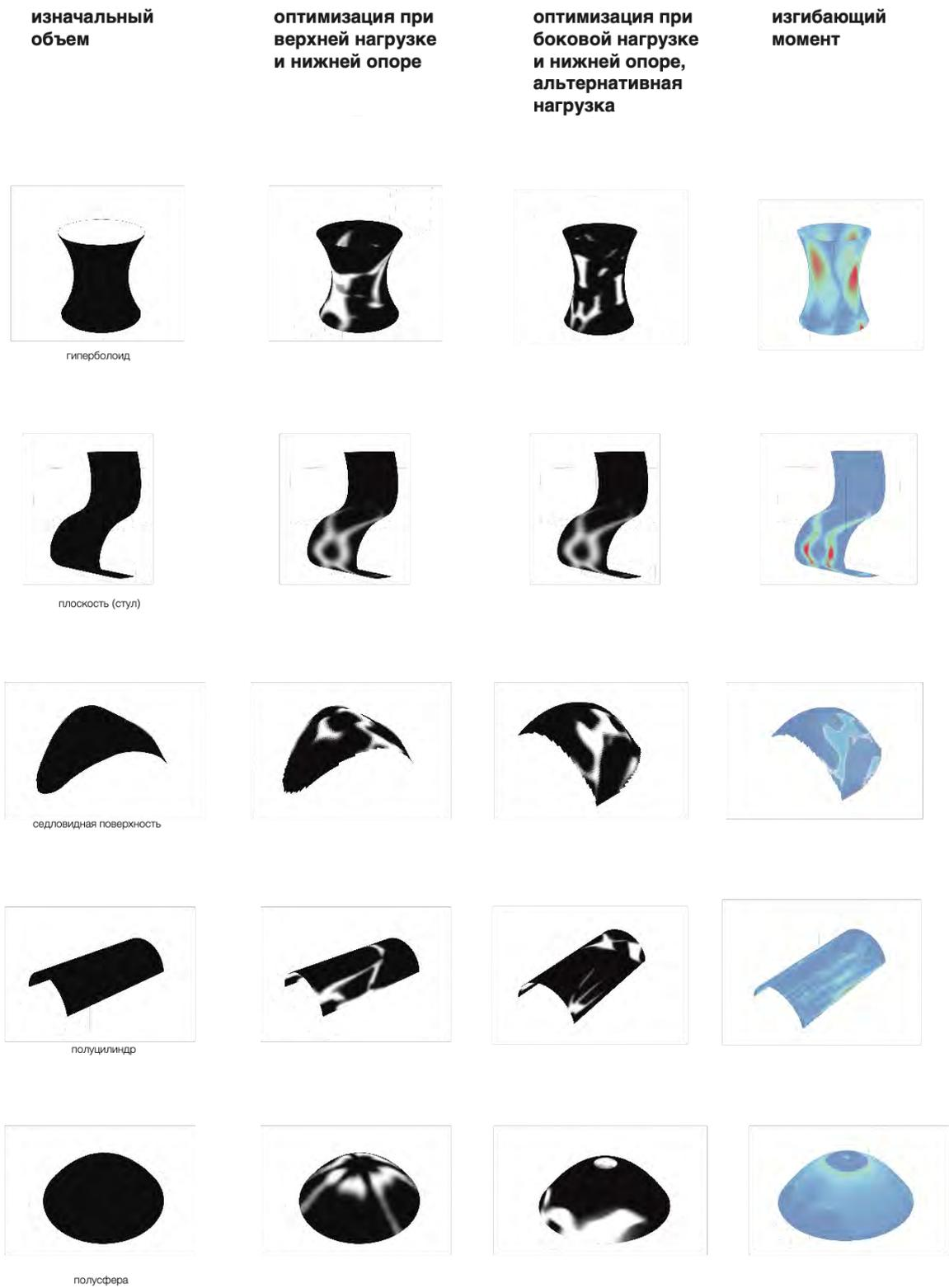
Рис. 129. Таблица результатов эксперимента с топологическими оптимизациями, за основу взяты различные геометрические формы
