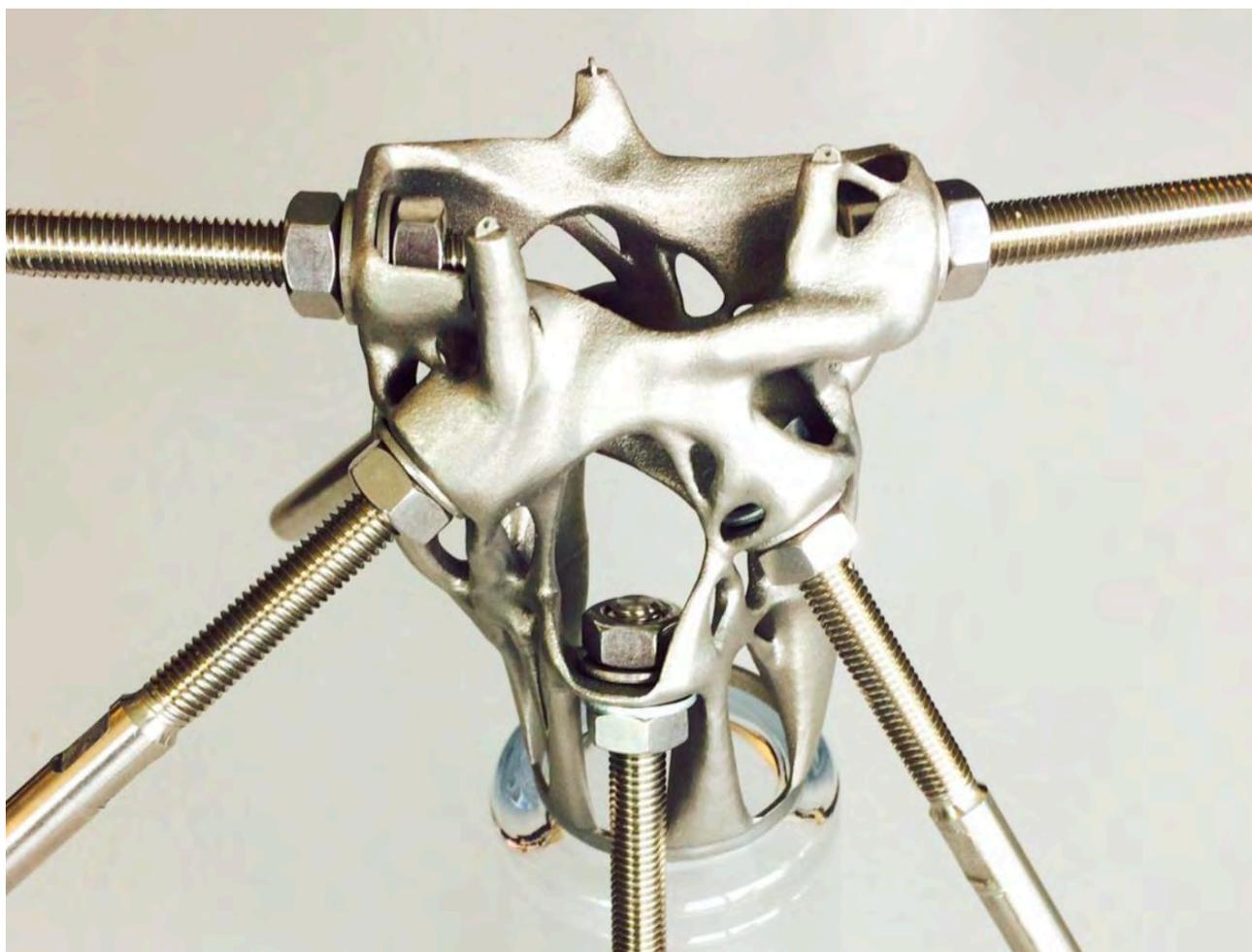
Рис. 60. Изображение оптимизированного узла из нержавеющей стали с присоединением резьбовых обжимных концов к кабелям, световая арматура и распорка отсутствуют, компания Agur, 2015
