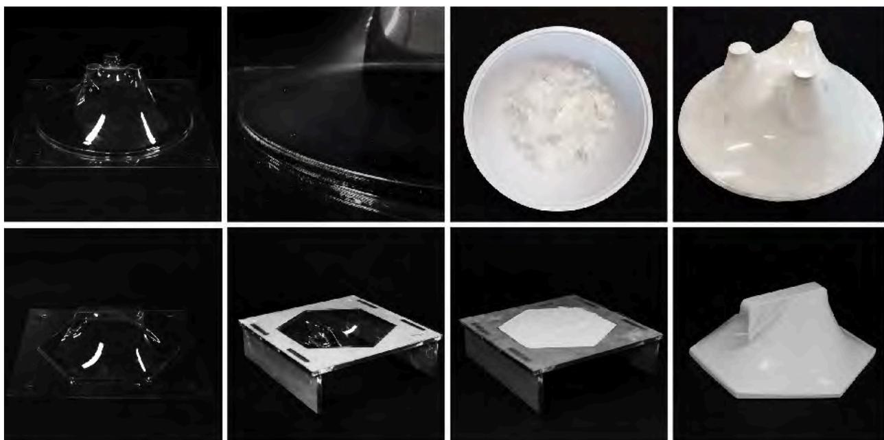
Рис. 113. Обзор формовки и литья с использованием армированного стекловолокном белого цемента
