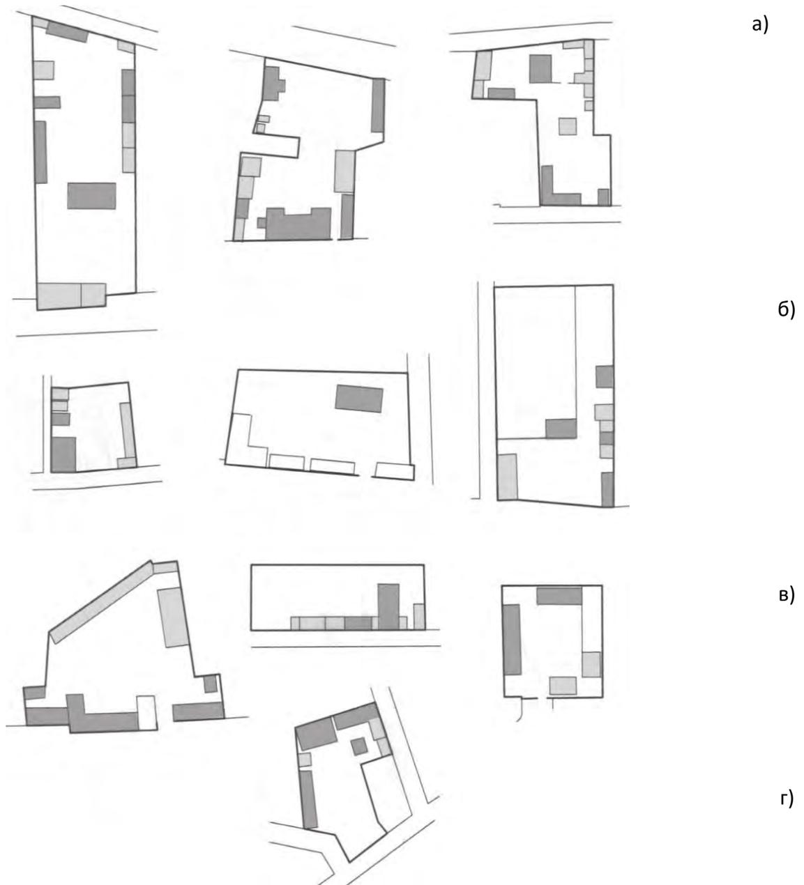
*Рисунок III.11. Схемы планировки некоторых владений Москвы в 1750-х годах, показанные в одном масштабе. а) дворы, расположенные между двумя «параллельными» улицами б) дворы, расположенные на углу между двух улиц в) дворы, имеющие только одну сторону, выходящую на улицу г) владения сложной формы, с трех сторон окруженный улицами. По материалам ГИМ ОПИ ф.440, Более темны цветом показаны жилые строения.*
