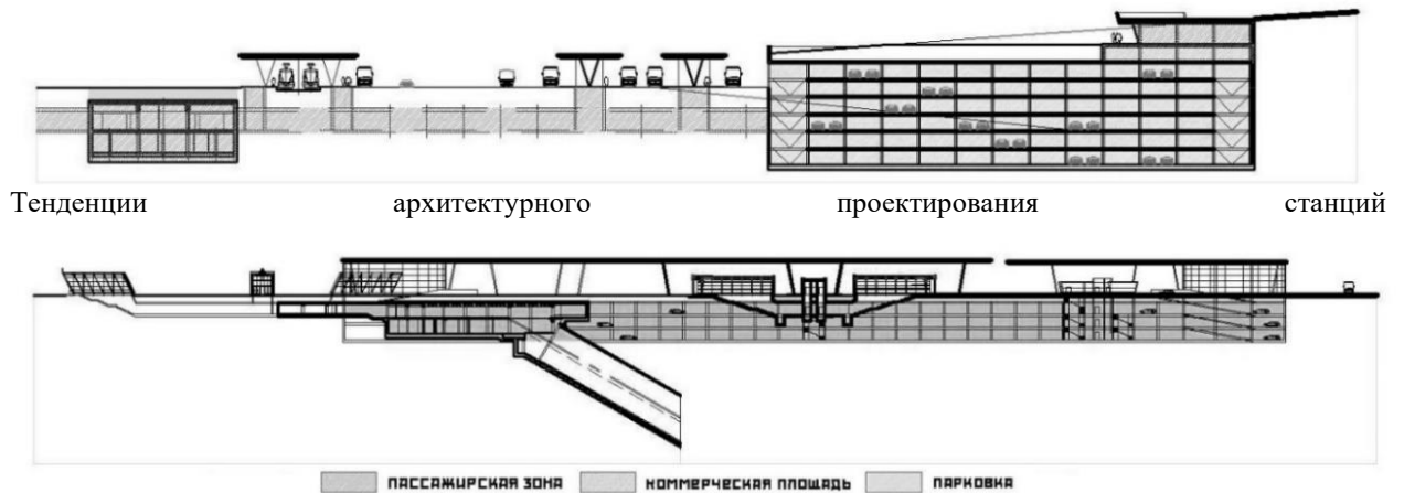
Рисунок 60. Схемы разрезов станций метрополитена с рассредоточением пассажиров на разные виды транспорта – интеграция с автобусными остановочными пунктами, перехватывающими парковками
