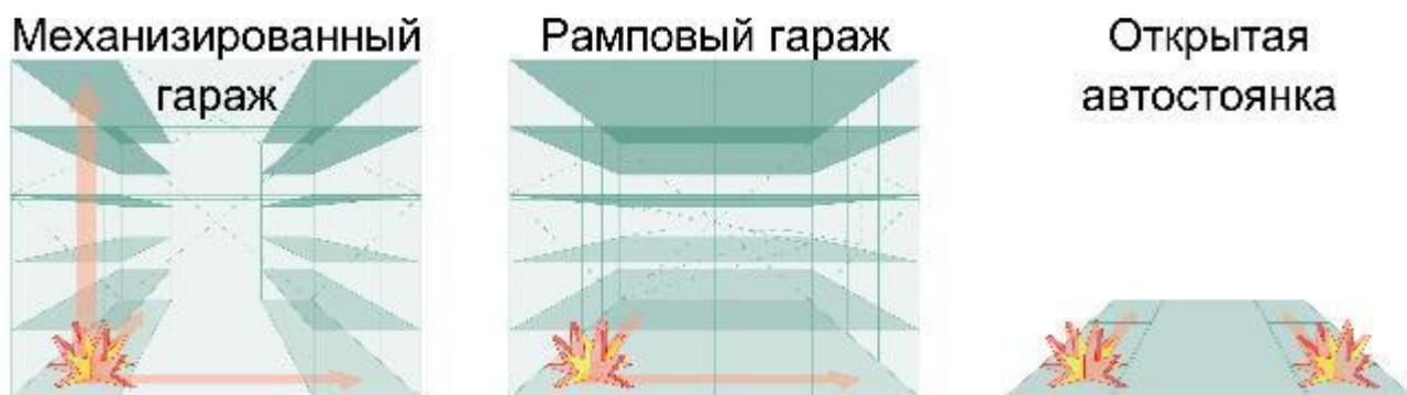
Рис. 21. Направление распространения огня в разных типах автостоянок
