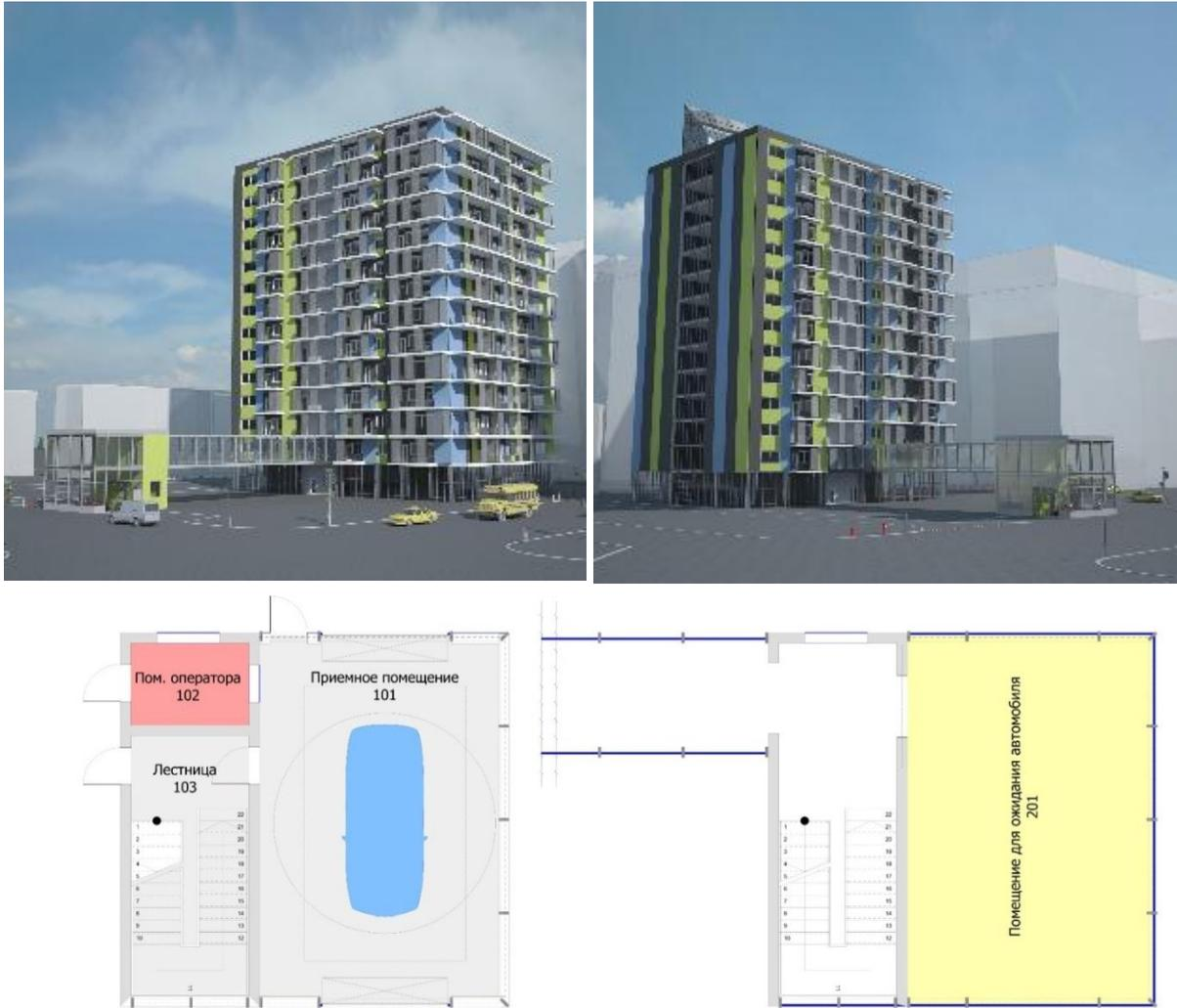
Рис. 24. Проектное предложение автора по расположению подземной механизированной автостоянки, соединенной с жилым комплексом переходом
