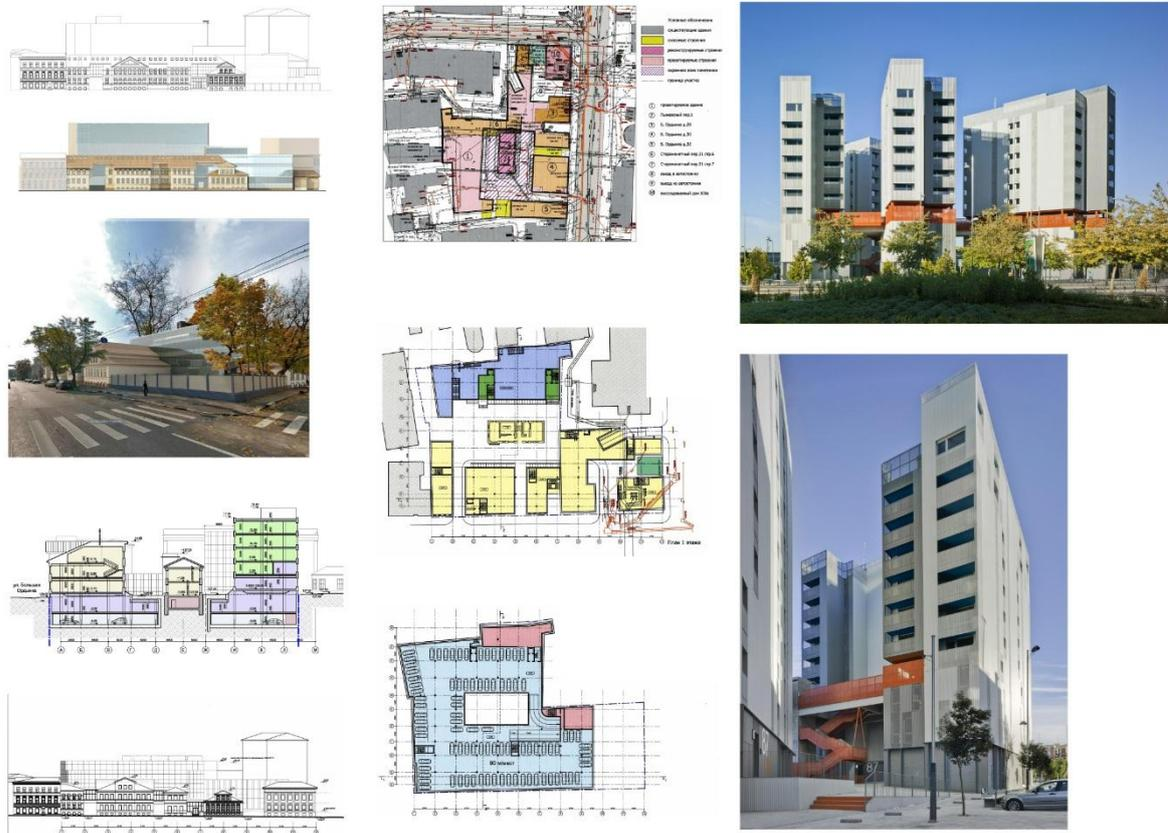
Механизированная автостоянка, встроенная в центральную часть жилого комплекса
