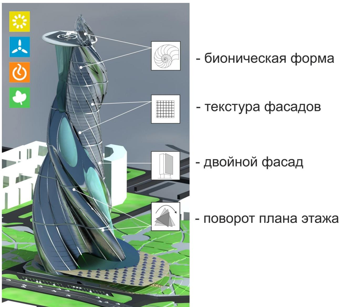
Рис. 49 Общий вид высотного здания с ВИЭ в г. Новосибирске
