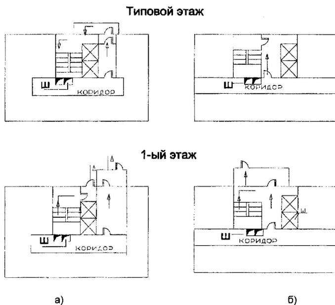
Рис.6 Планировка лестнично-лифтовых узлов (а – лестница в незадымляемой лестничной клетке 1-го типа с переходом через наружную зону – балкон; б – лестница в незадымляемой лестничной клетке 2-го типа; ш – шахта дымоудаления). При планировке (а) воздух подается сверху только в лифтовую шахту, при планировке (б) воздух подается в лестничные клетки и лифтовые шахты. Удаление воздуха через шахту (ш) коридора с каждого этажа для всех случаев планировок
