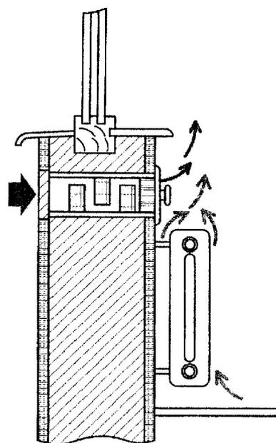
Схема приточного клапана, расположенного в стене под оконным проемом
