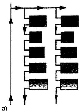
Рис.11 Соединение отопительных приборов при однотрубной (а) и двухтрубной системе отопления (б)
