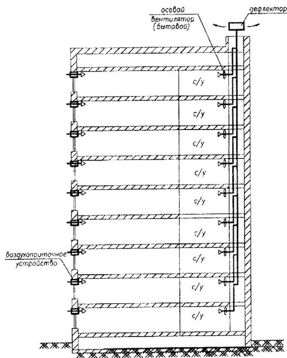
Схема механической вытяжной вентиляции с бытовыми осевыми вентиляторами в каждой квартире и естественным притоком
