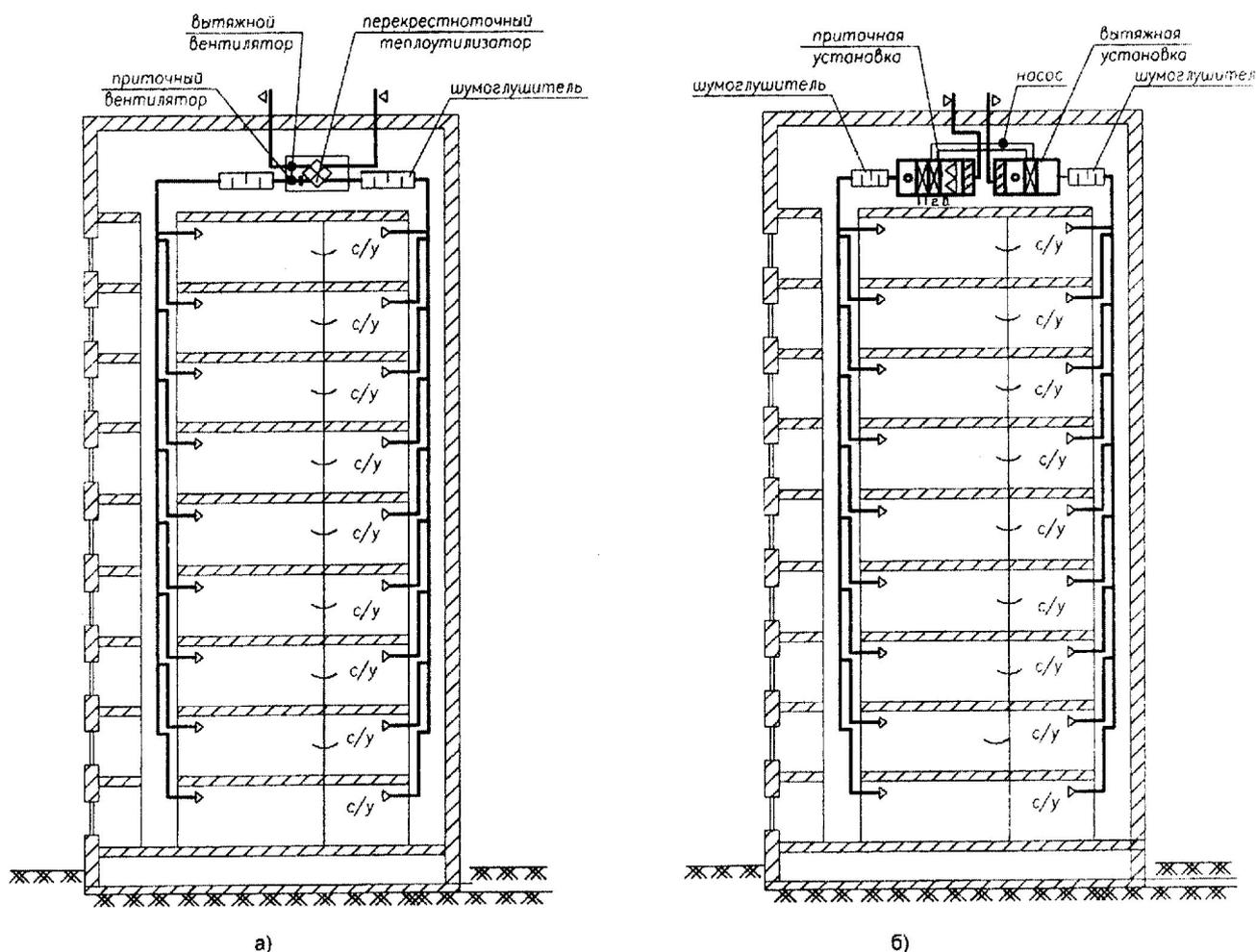
Схема централизованной механической приточно-вытяжной вентиляции с утилизацией тепла удаляемого воздуха (а – с перекрестноточным теплоутилизатором, б – с гликолевыми теплообменниками)
