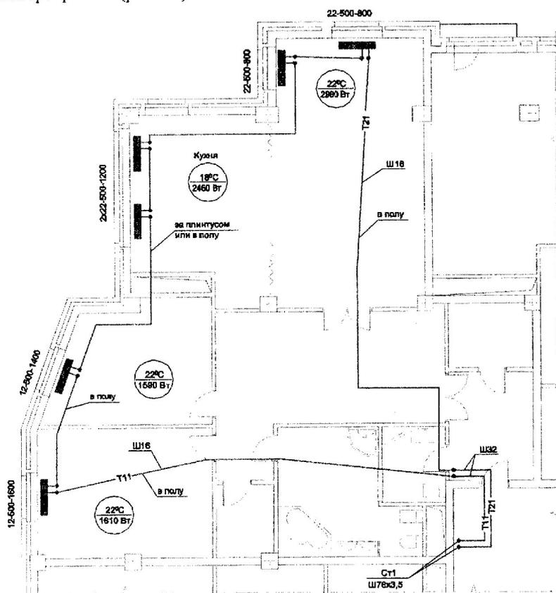
Рис.14 План квартиры с однотрубной горизонтальной системой отопления
