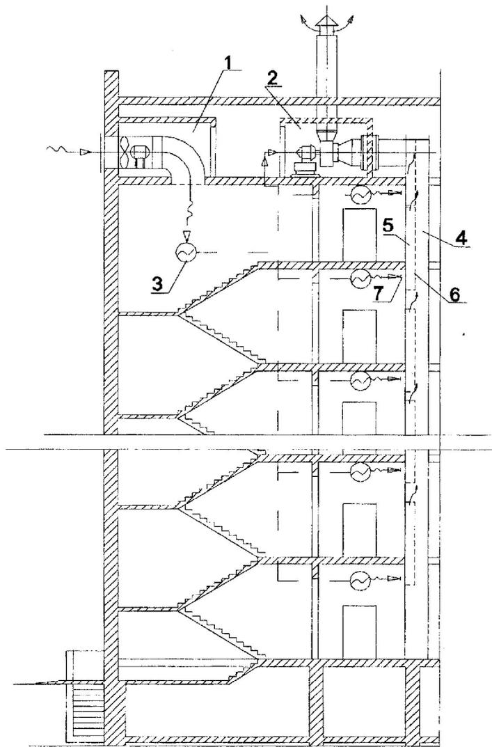
Рис.5 Противодымная установка лестничной клетки (1 – приточная установка; 2 – вытяжная установка; 3 – система автоматики; 4 – блок-шахта; 5 – канал; 6 – рассечка; 7 – клапан)
