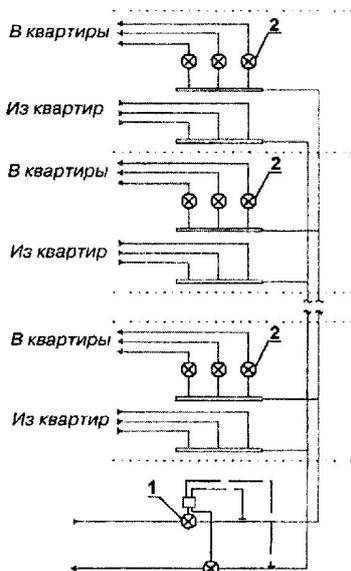
Рис.12 Схема поквартирного учета тепла (1 – домовый теплосчетчик, 2 – узел поквартирного учета на лестничной клетке)
