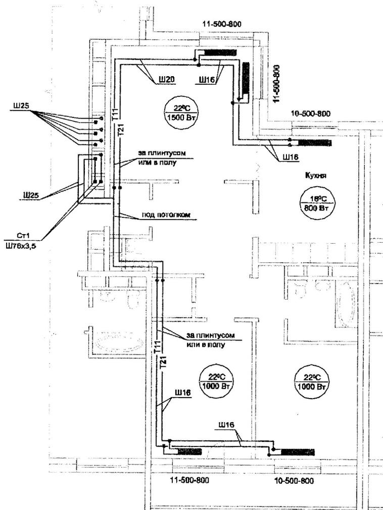
Рис.18 План квартиры с двухтрубной периметральной системой отопления
