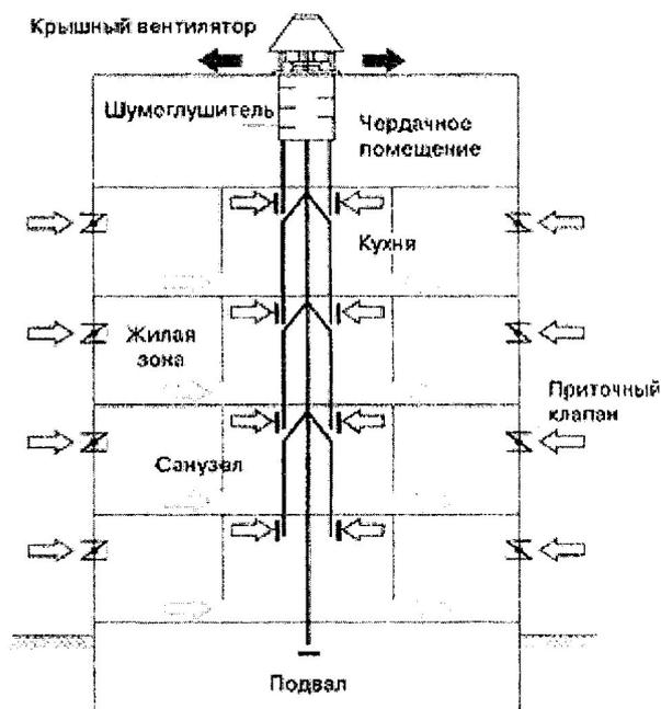
Схема централизованной механической вытяжной вентиляции с естественным притоком
