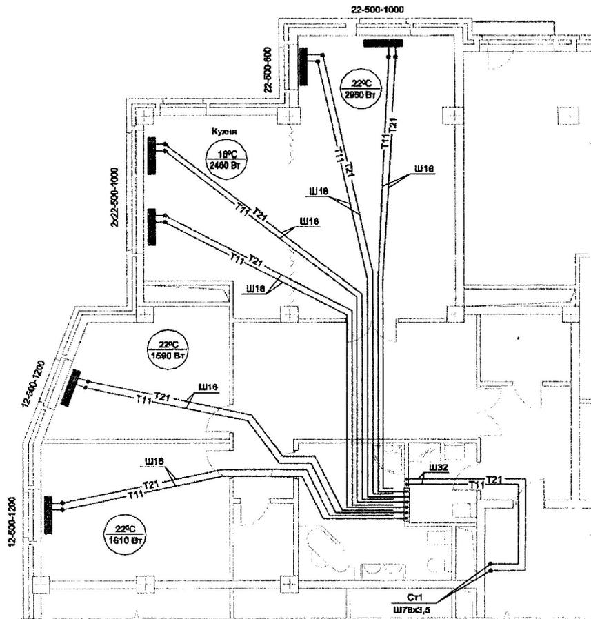
Рис.19 План квартиры с двухтрубной лучевой системой отопления
