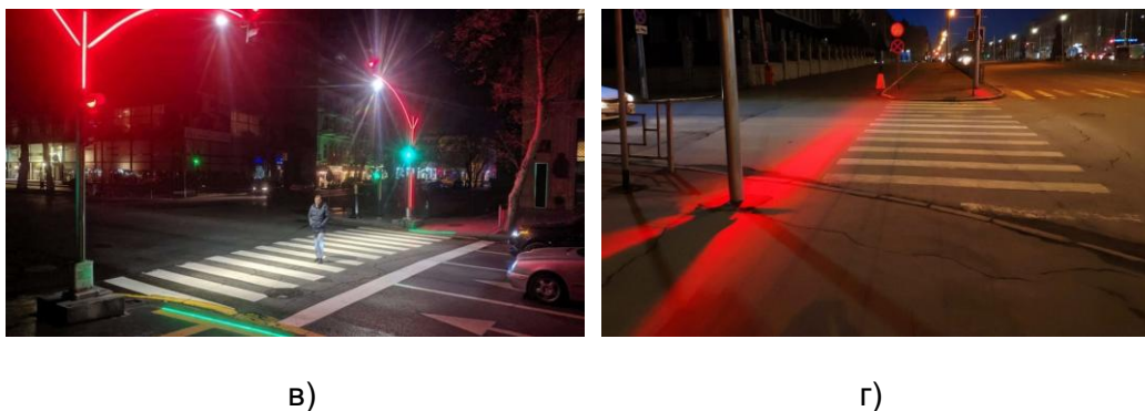
Рис. 5. Инновационные светофоры: а) с боковой светящейся поверхностью; б) с дополнительной подсветкой опоры и дублирующими знаками; в) с множественной комбинированной дополнительной подсветкой; г) со световой проекцией на поверхность земли
