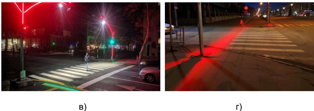
Рис. 5. Инновационные светофоры: а) с боковой светящейся поверхностью; б) с дополнительной подсветкой опоры и дублирующими знаками; в) с множественной комбинированной дополнительной подсветкой; г) со световой проекцией на поверхность земли
