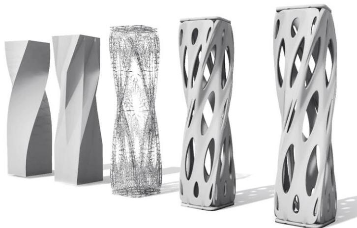
Рис. 8. Применение плагина «Weaverbird» для создания формы при параметрическом проектировании в среде Rhinoceros 3D + Grasshopper
