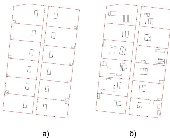
Рис. 3. Сравнение первоначальной и сложившейся к настоящему времени плотности застройки. Фрагмент территории СНТ «Волна», Раменского городского округа, Московской области: а) графическая реконструкция планировки по типовым планам участков на момент начала застройки; б) существующее положение
