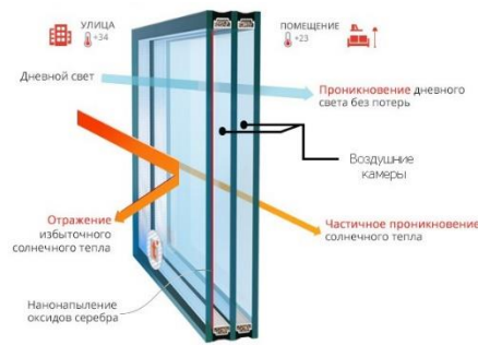
Рис. 8. Принцип действия двухслойного стеклянного окна
