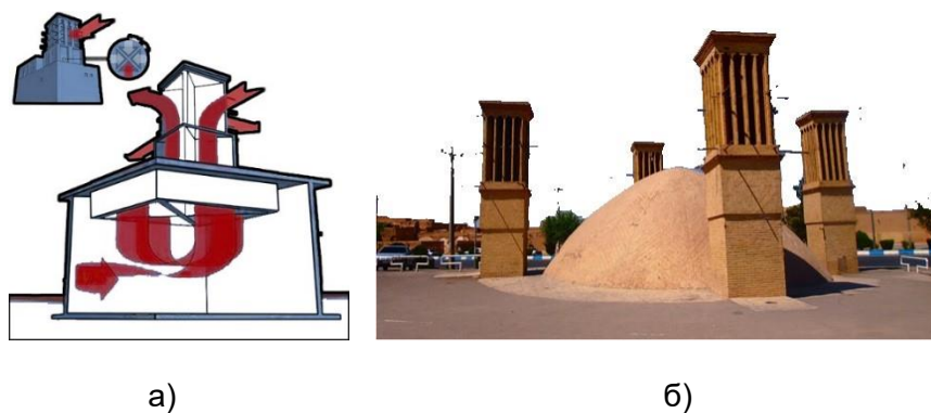
Рис. 9. Первая схема работы ветровой башни: а) схема движения воздушных потоков в багдире; б) ветровые башни в Иране
