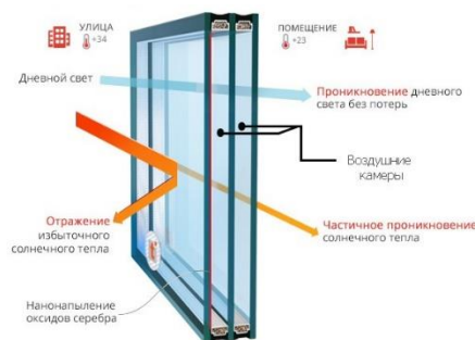
Рис. 8. Принцип действия двухслойного стеклянного окна
