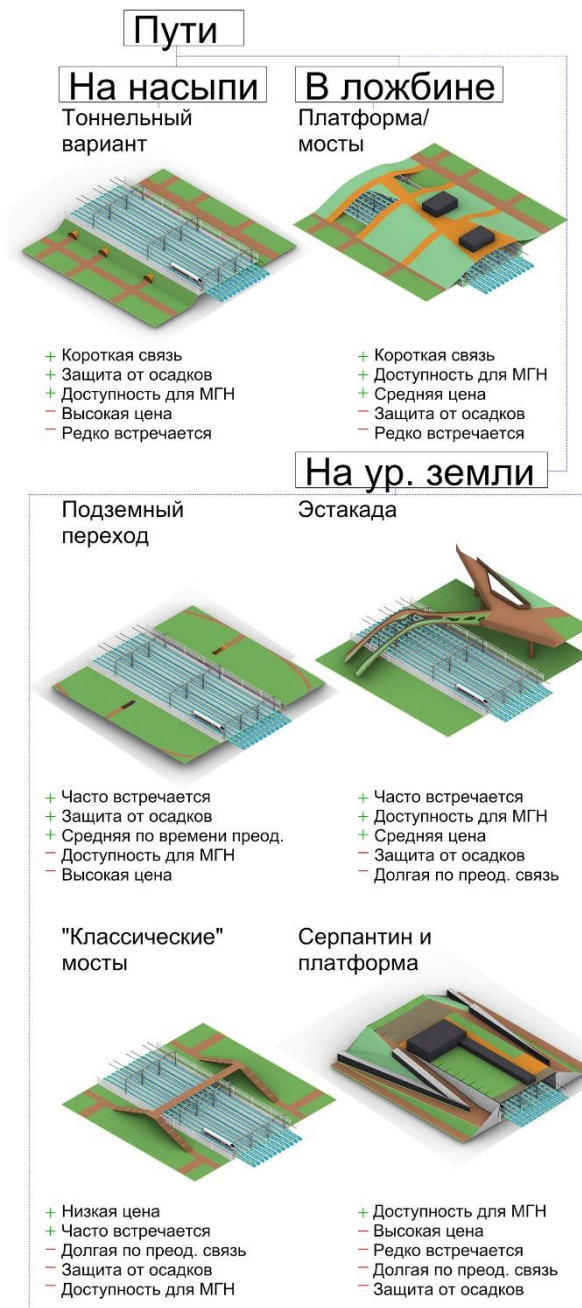
Рис. 11. Предлагаемая классификация организации связей, преодолевающих линейные разделители, в т.ч. железные дороги, в зависимости от расположения путей
