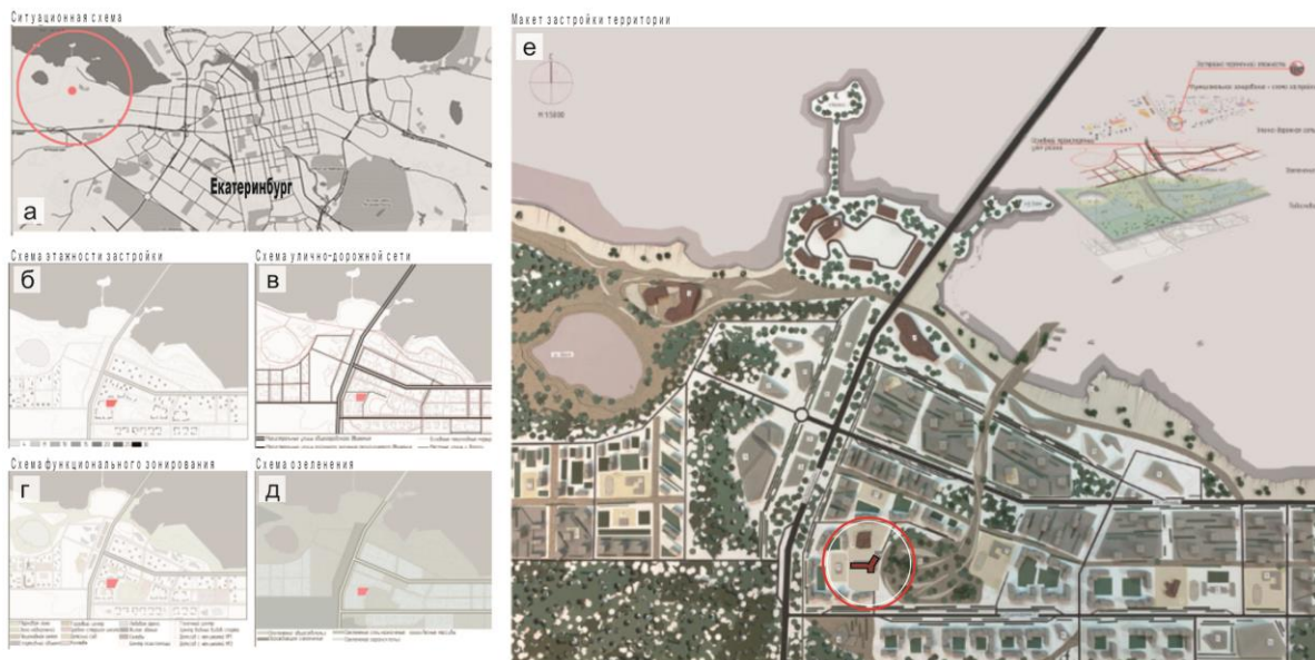
Рис. 1. Фрагмент курсового проекта. Учебно-воспитательный центр: а – ситуационная схема; б – схема этажности застройки; в – схема улично-дорожной сети; г – схема функционального зонирования; д – схема озеленения; е – макет застройки территории. Студ. Якубовская А., 5 курс. Рук. Н.В. Ламехова, А.В. Меренков (Диплом II степени «Лучший проект 2021-2022», г.Нижний Новгород)
