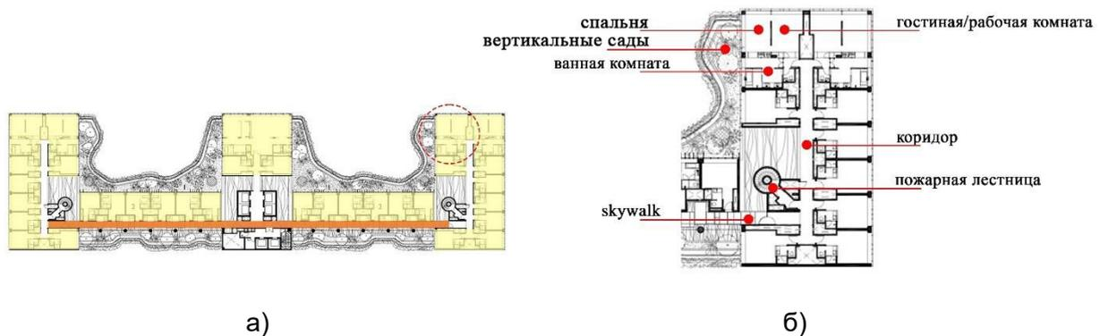
Рис. 8. План уровня жилых номеров гостиницы: а) план типового этажа с указанием номеров; б) решение планировки жилого номера
