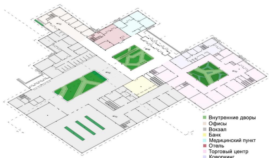
Рис. 12. Климатическая адаптация на первом этаже вокзального комплекса за счет размещения внутренних дворов
