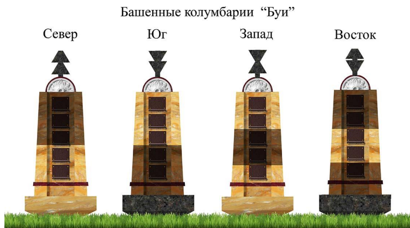
Рис. 12. МАФ-колумбарий с урнохранилищами столпного типа «Буй» с нишами закрытого типа, выполненными по мотивам морских буев для кремационного мемориального парка в Севастополе (по проекту П.А. Безшлеевой)
