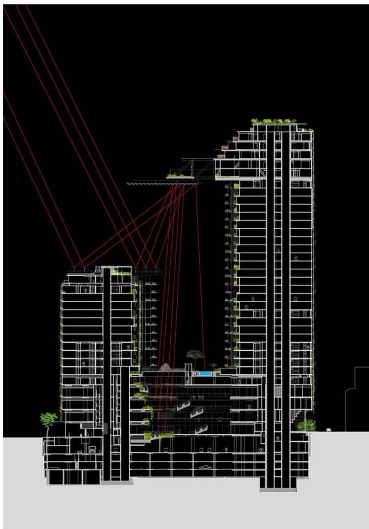
Рис. 7. Вертикальные сады Патрика Бланка. Освещение при помощи управляемых зеркал, расположенных в центральной части здания, позволяющие обеспечить необходимый уровень освещения на всех фасадах комплекса отражая солнечный свет
