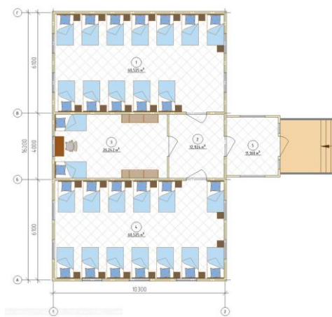
Рис. 11. Схема объемно-планировочного решения спального корпуса ДОЦ «Спутник» до изменений; 2022 г. Условные обозначения: 1, 4 – комната отряда; 2 – коридор; 3 – комната вожатых; 5 – тамбур
