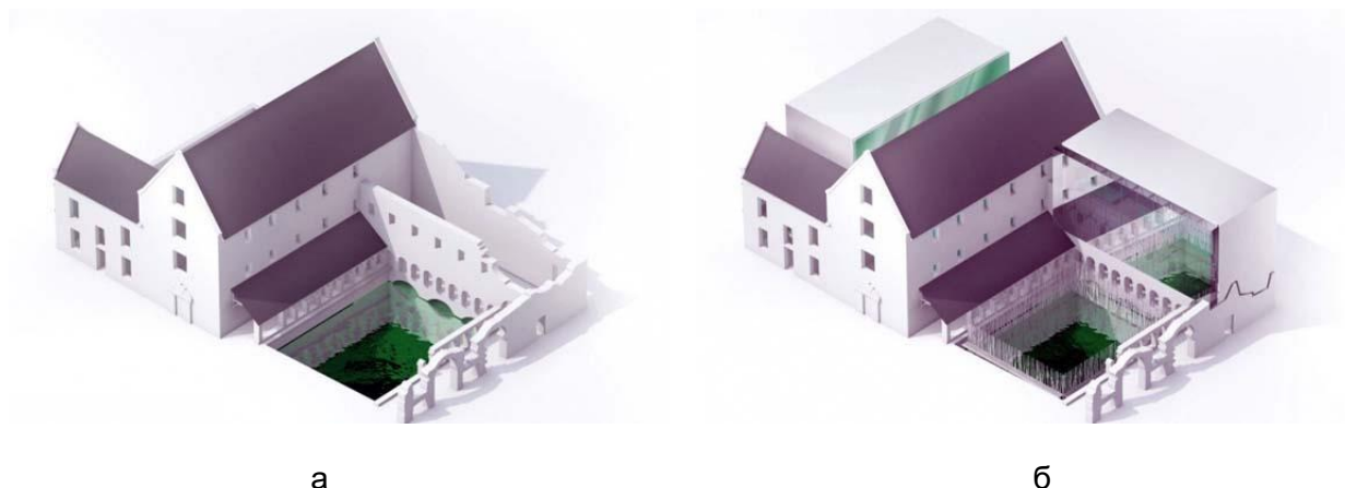
Рис. 3. Схема объемно-пространственных характеристик монастыря: а) схема сохранившихся фрагментов, 2012 г.; б) проектное предложение, 2012 г.
