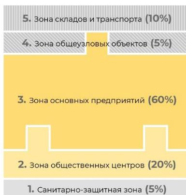
Рис. 7. Схема функционального зонирования территории промышленного района
