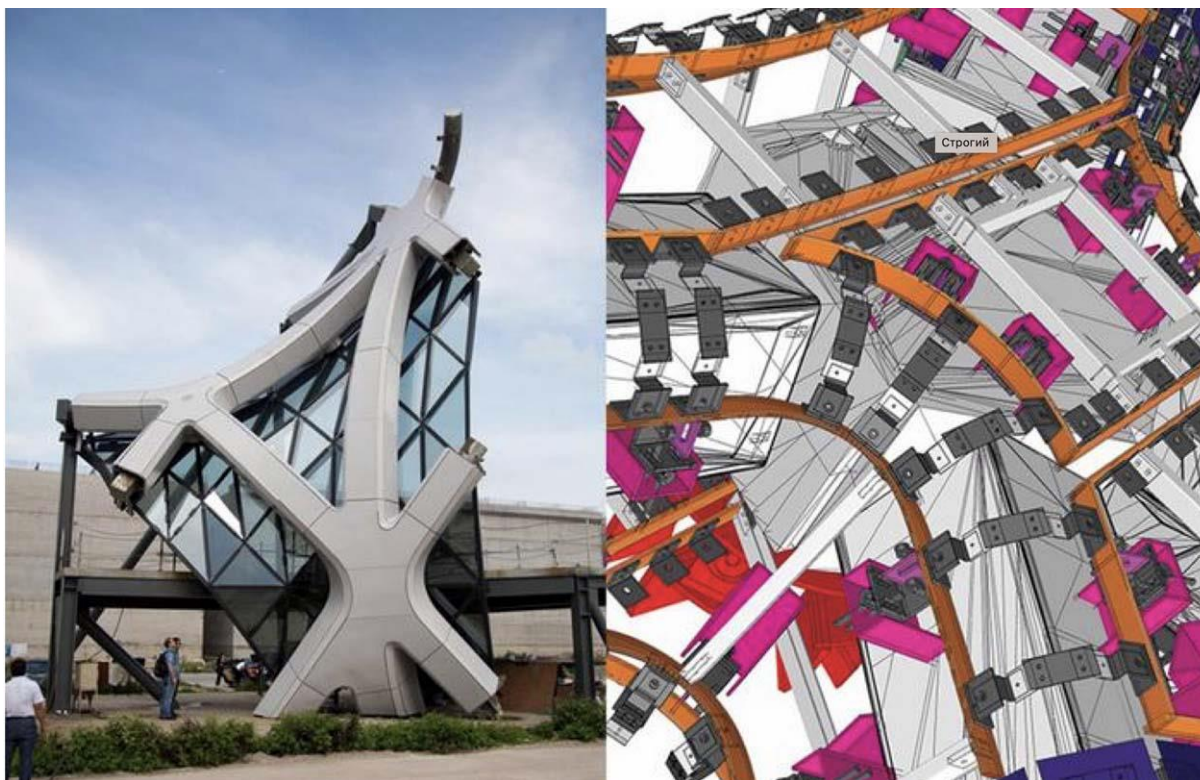
Рис. 3. Алгоритмическое моделирование элементов здания (деталей фасада), Отель Морфейус, Zaha Hadid Architects, Китай, 2018
