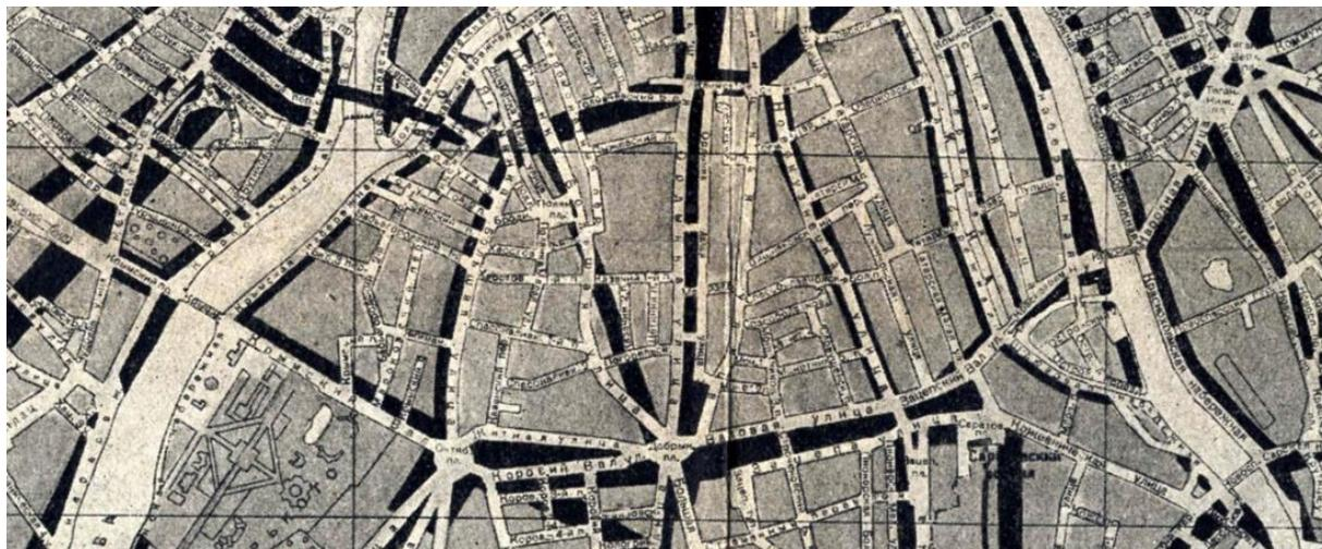
Рис. 4. 1935. Генеральный план реконструкции города Москвы. Схема пробивки новых и реконструкции старых магистралей центральной части гор. Москвы (фрагмент)
