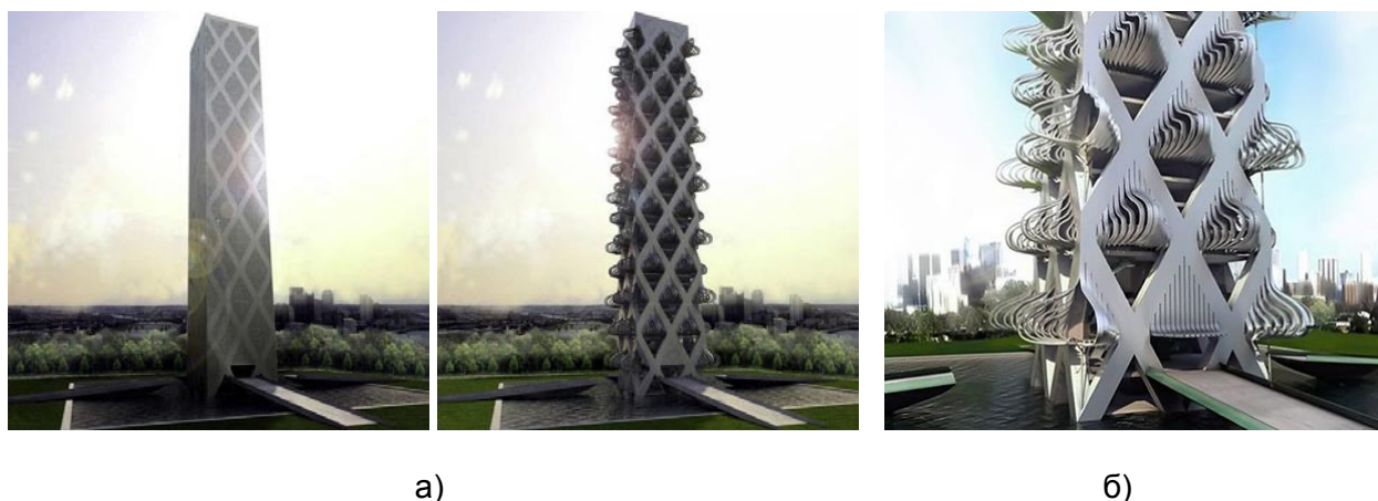
Рис. 4. Проект «Kinetower». 2011 г. Архитекторы Barbara van Biervliet, Xaveer Claerhout: а) общий вид в стационарном и трансформируемом состоянии; б) фрагмент фасада в процессе реакции оконных конструкций на интенсивность солнечного света
