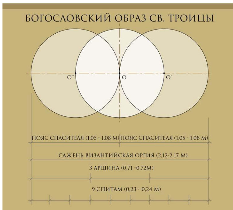
Рис. 3. Геометрический анализ меры Пояс Иисуса Христа, раскрывающий богословские понятия св. Троицы и двойной природы Иисуса Христа, применявшийся в древнерусском храмостроении X–XV вв. Условные обозначения: O – центр серединного круга; O', O'' – центры двух дополнительных кругов, равных центральному, строящиеся для последующего размерения квадрата, равного кругу по площади («квadrатура круга»).
