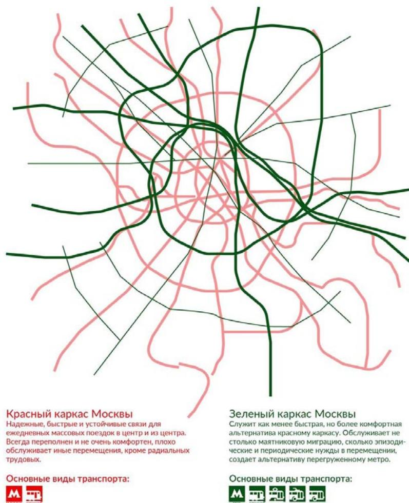
Рис. 6. «Красный» и «зеленый» транспортные каркасы города. Тонкие линии зеленого каркаса обозначают обособленные линии наземного транспорта, толстые - внеуличный транспорт (МЦК и МЦД)
