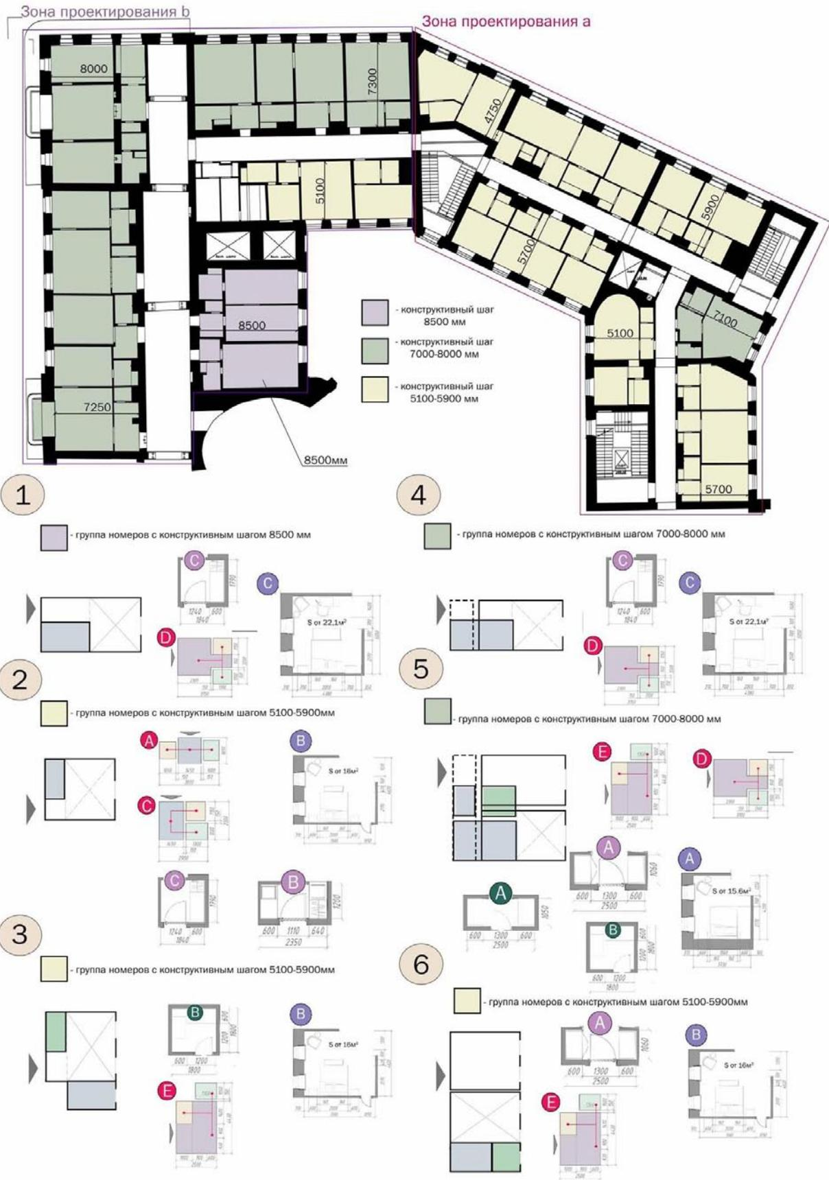
Рис. 5. Конструктивный шаг и комбинаторика помещений с минимальными размерами
