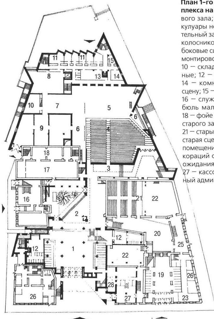
Рис. 3. План первого этажа реализованного проекта театрального комплекса на Таганке, объединившего в одном объеме семь зданий
