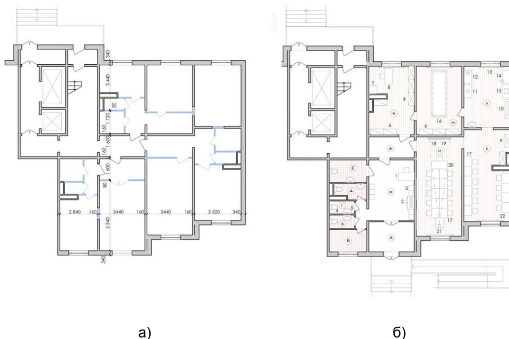
Рис. 5. Вариант перепланировки помещений первого этажа в типовом жилом здании серии МЭС-84 под деятельность учреждения дополнительного образования:
