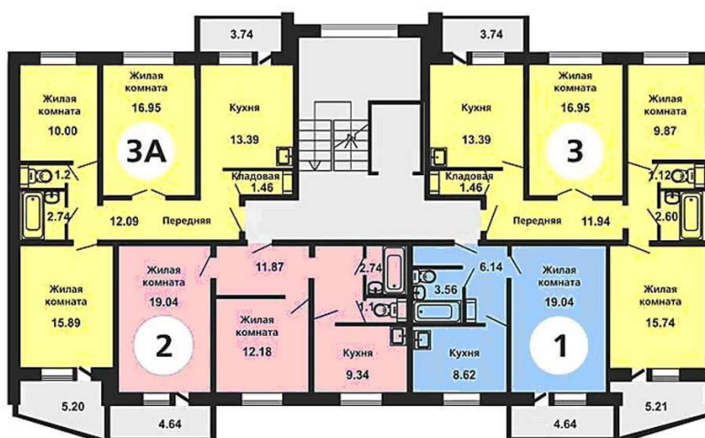
Рис. 2. Вариант №2 компоновочного решения лестничных площадок
