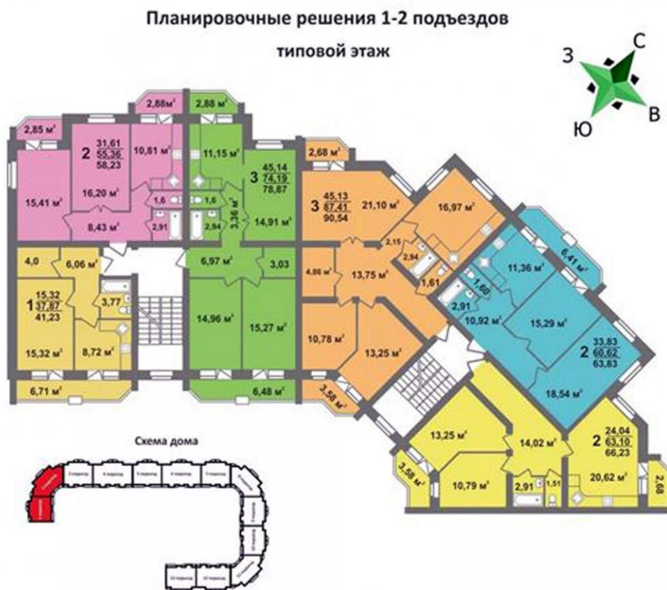
Рис. 1. Вариант №1 компоновочного решения лестничных площадок
