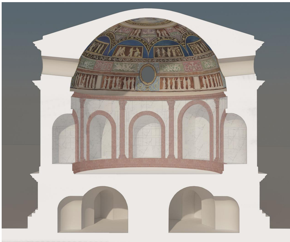
Рис. 9. Перспективный поперечный разрез мавзолея Тор де Скьяви (реконструкция авторов).
