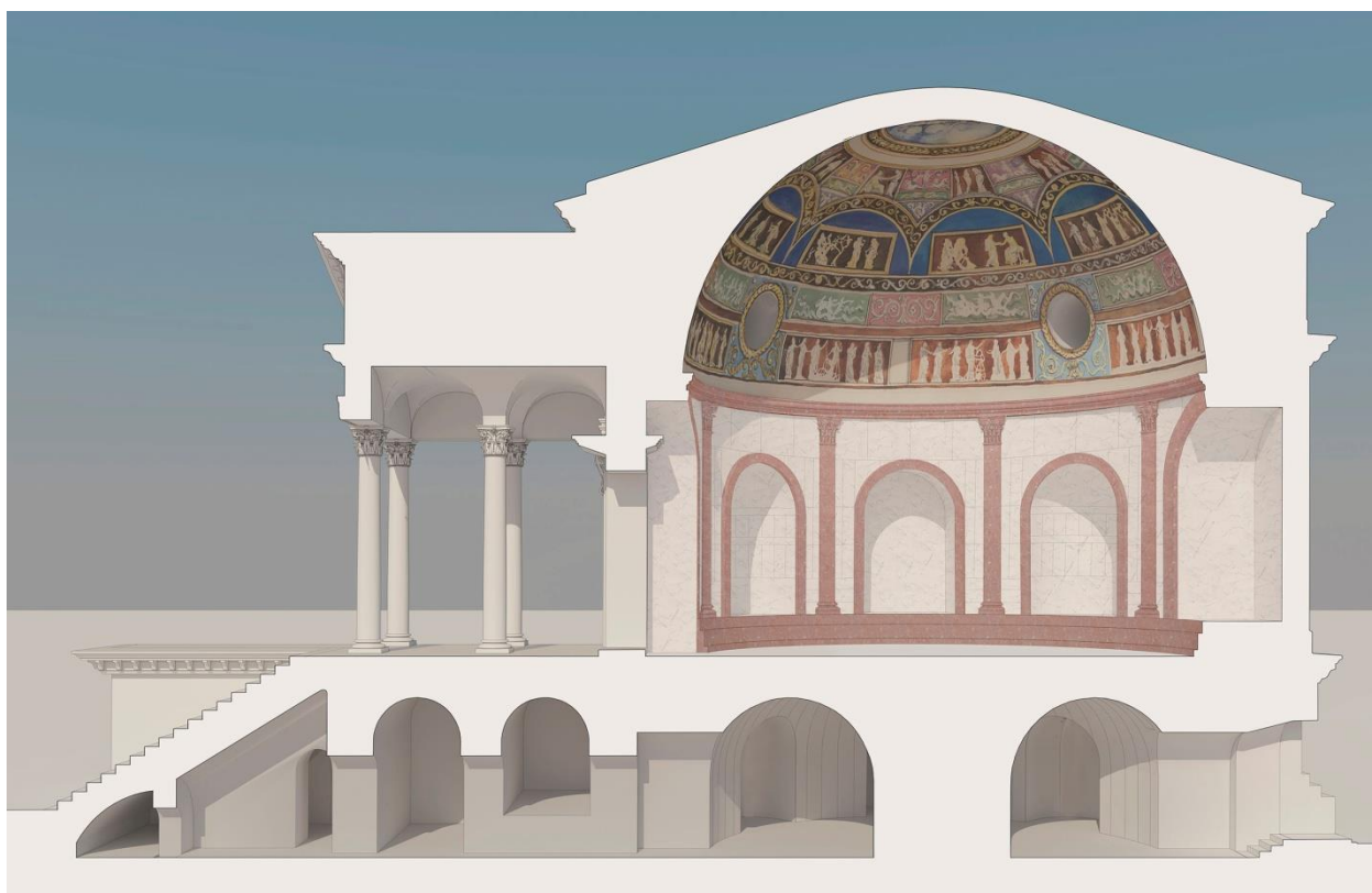
Рис. 8. Перспективный продольный разрез мавзолея Тор де Скьяви (реконструкция авторов)
