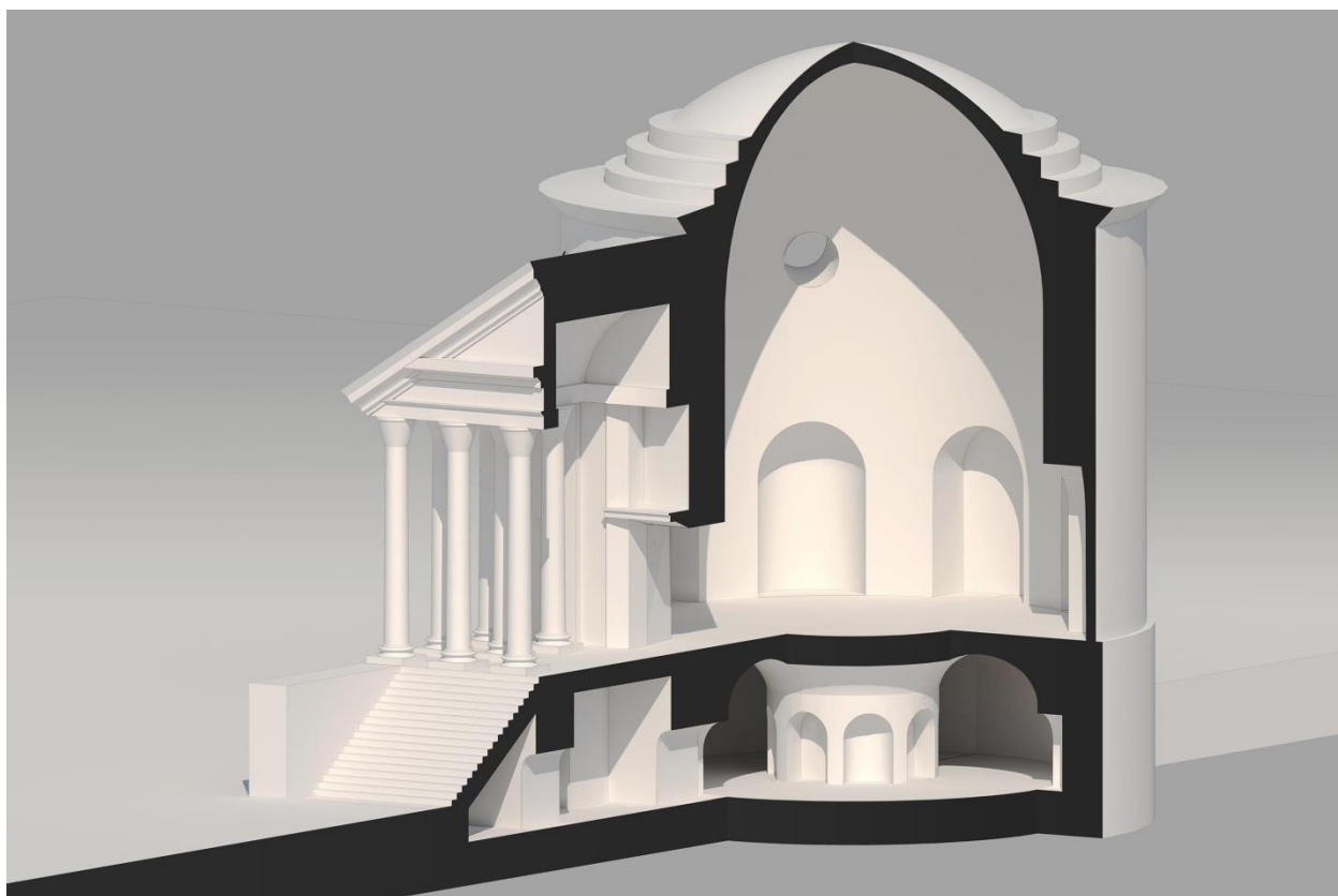
Рис. 14. Аксонометрический разрез мавзолея Максенция (реконструкция авторов)
