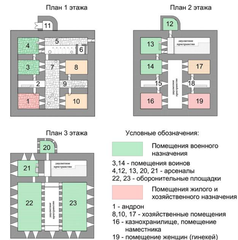
Рис.7. Функциональное зонирование и экспликация предполагаемых помещений
