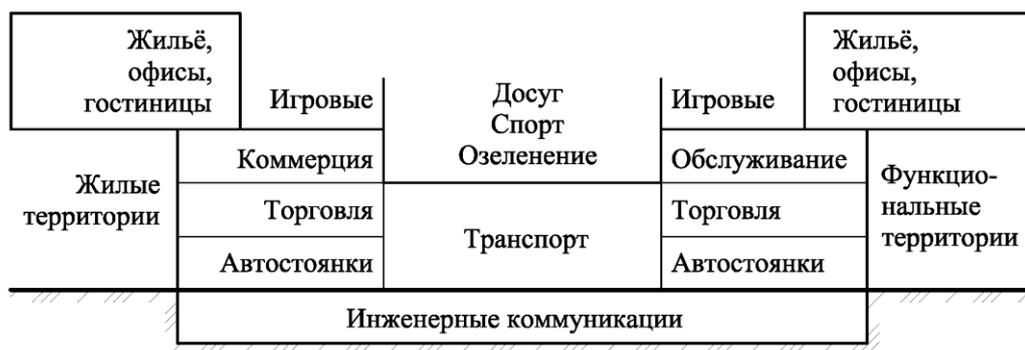
Рис. 4. Линейный многофункциональный комплекс. Схема. Разрез
