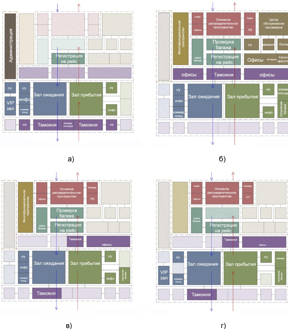
Рис. 9(а-г). Типовая функционально-структурная схема на примере рассматриваемых объектов: а) вокзал в Венеции (Италия); б) вокзал в Гаосюне (Тайвань); в) вокзал в Йокогаме (Япония); г) вокзал в Сингапуре (Сингапур)
