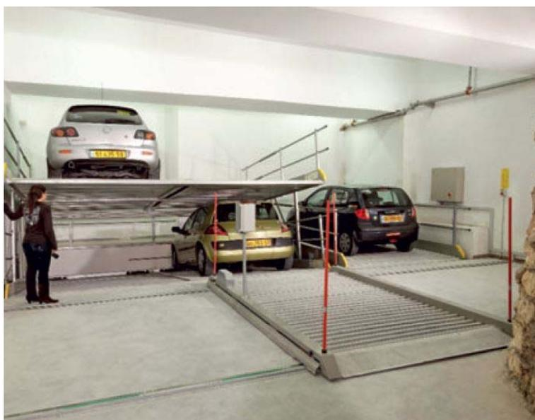
Рис. 3. Пример применения зависимой механизированной парковки в рамповом гараже
