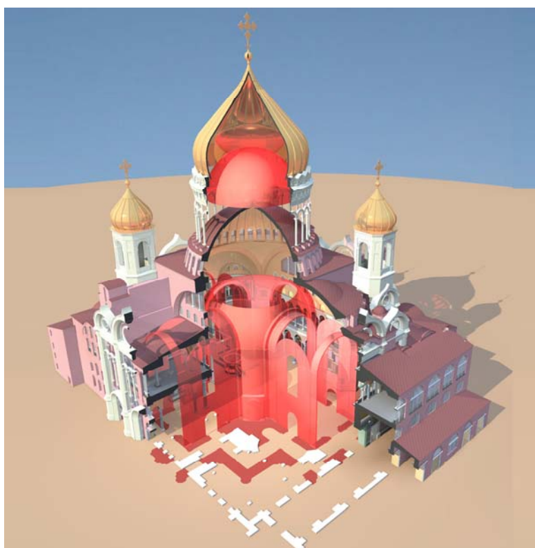
Рис. 24. Совмещенный перспективный разрез собора Св. Софии и храма Христа Спасителя
