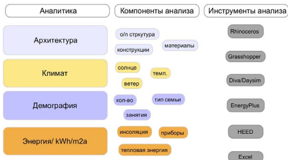
Рис. 8. Схема отношений между аналитическими процедурами и программными модулями, применяемая для исследования адаптивной реорганизации жилых кварталов с индивидуальными жилыми домами в Сербии
