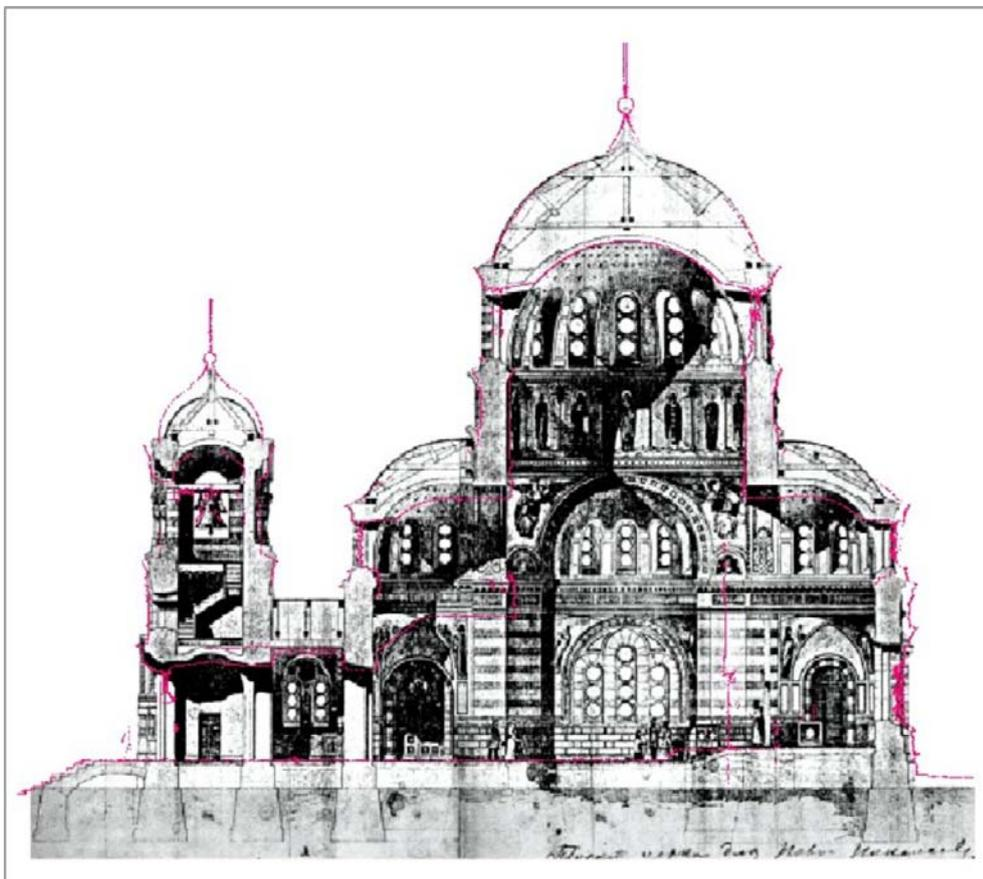
Рис. 12. Сопоставление проектного чертежа с обмерами
