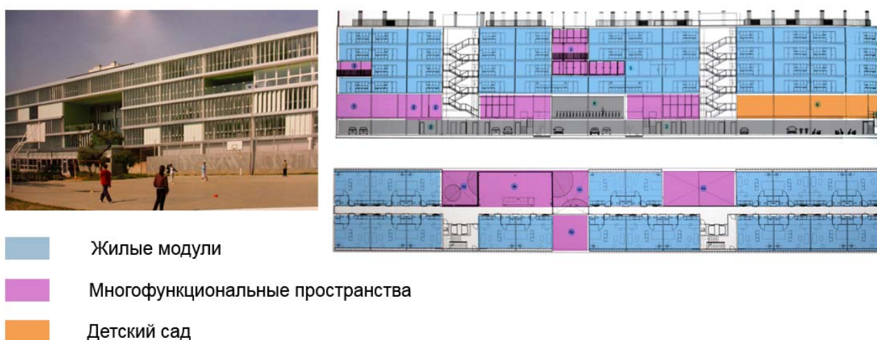
Рис. 11. Youth Housing, Nursery and Occupational Centre, арх. Blanca Lleo (Барселона, Испания): слева – общий вид, справа сверху – разрез, справа внизу – план второго этажа
