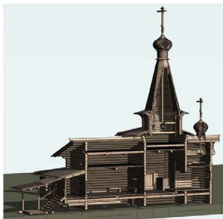
Рис. 7. Некоторые виды составных элементов информационной модели памятника архитектуры и общий вид в разрезе
