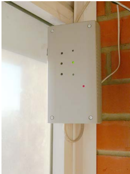
Рис. 3. Трехканальный датчик освещенности
