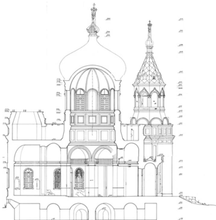
Рис. 6. Продольный разрез. Обмерный чертёж храма Воскресения Христова
