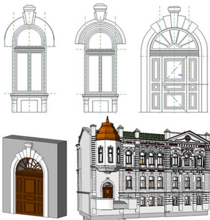
Рис. 2. Библиотечные элементы окон и дверей «Гостиницы Метрополитен»
