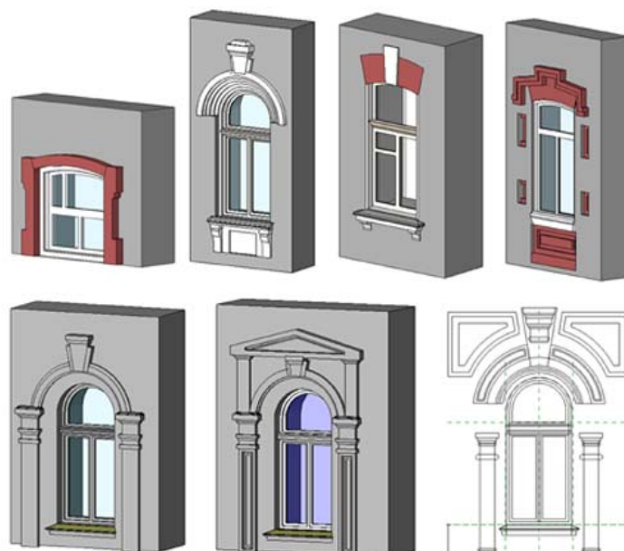
Рис. 4. Библиотечные элементы окон «Дома композиторов» и «Гостиницы Метрополитен»
