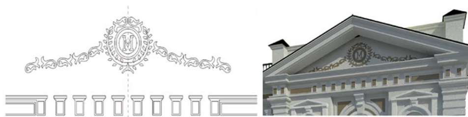
Рис. 3. Библиотечные элементы накладных архитектурных деталей «Гостиницы Метрополитен»
