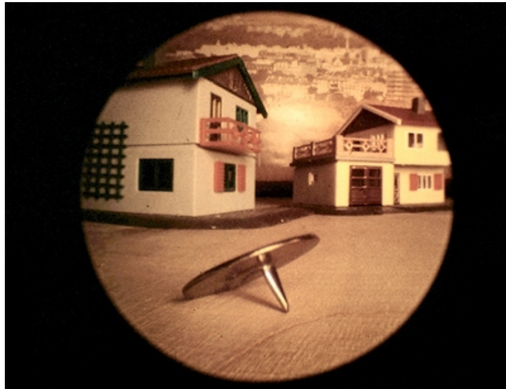
Рис. 4а. Простая самодельная портативная установка (МАРХИ, 80-е годы XX века), которую можно было устанавливать в проектных аудиториях (без возможности фотофиксации). Эндоскоп этой установки (с подвижной призмой) позволял в широких пределах менять направление наблюдения в вертикальной плоскости.
