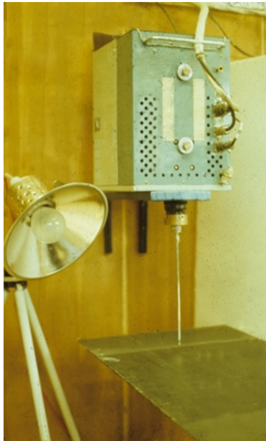
Рис. 4а. Простая самодельная портативная установка (МАРХИ, 80-е годы XX века), которую можно было устанавливать в проектных аудиториях (без возможности фотофиксации). Эндоскоп этой установки (с подвижной призмой) позволял в широких пределах менять направление наблюдения в вертикальной плоскости.
