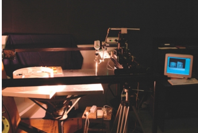
Рис. 6а. Модернизированная установка с использованием оборудования фирмы “Karl Storz”. Сохранены первоначальное координатное устройство и микрометрический винт.
