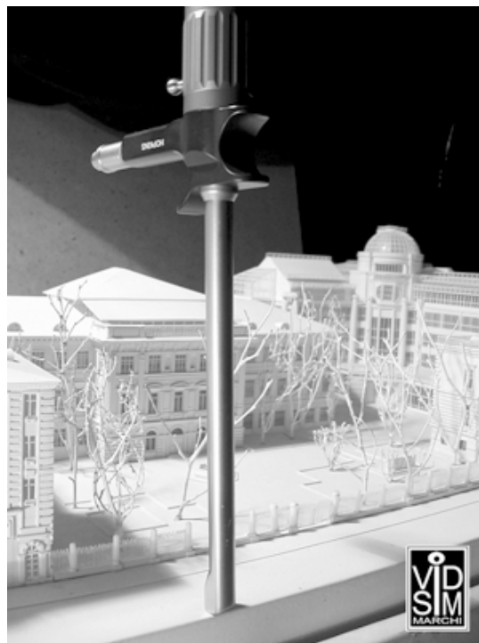
Рис. 6б. Технический эндоскоп (борескоп) “Karl Storz” с уникальной цилиндрической оптикой “HOPKINS” на фоне макета МАРХИ.
