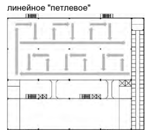
КОМПОНОВКА ОСНОВНЫХ СХЕМ ПРОИЗВОДСТВА
