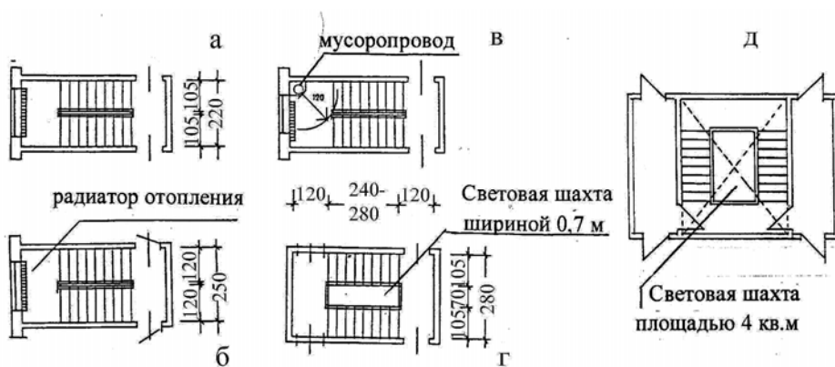
Рис.4. Основные типы лестниц в безлифтовых домах: а) для 2-4 этажных домов; б) для коридорных домов; в) для домов с мусоропроводом; г) с верхним освещением через фонарь для 2-3 этажных домов; д) с верхним освещением через фонарь для 5-6 этажных домов.
